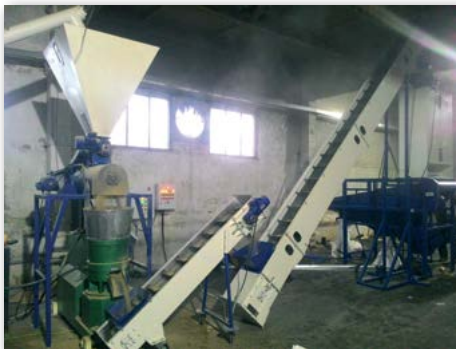
Линия производства гранулированного комбикорма. Казахстан
